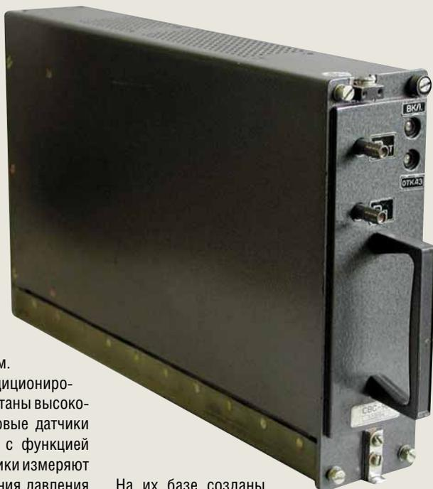
На их базе созданы цифровые измерители давления, которые используются в качестве эталонов для поверки приборов давления, а также для измерения атмосферного давления на метеостанциях аэропортов и службы погоды.
